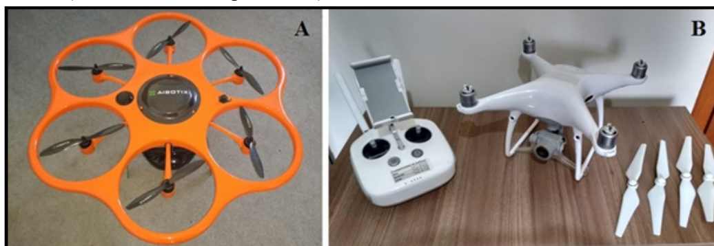
Figura 3. A- aeronave Aibot X6; B – aeronave Phantom 4 Pro.
