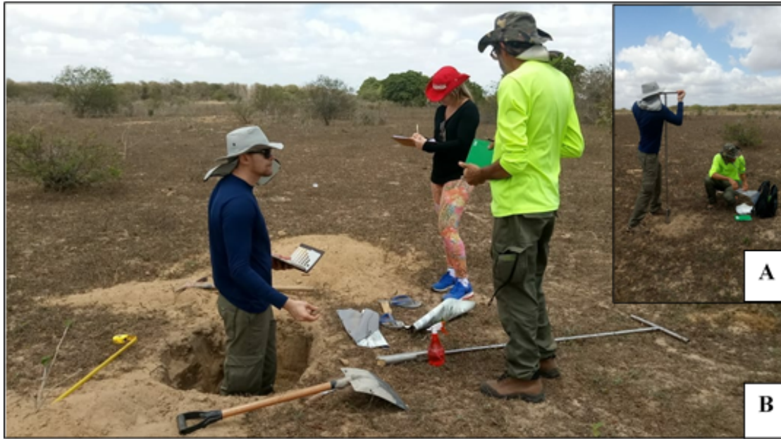
Figura 05. Procedimentos de amostragem de solo em campo, utilizando-se de tradagem (A) e trincheira (B) e algumas ferramentas auxiliares, necessárias na descrição de perfil de solo em área planejada de caatinga.
